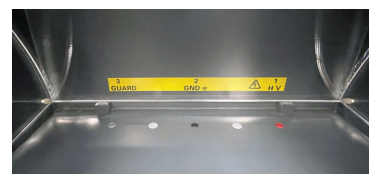
Raccordement sur bornes internes de l'équipement à tester
