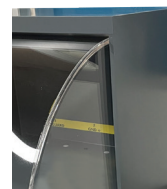
Enveloppe de la cage en PVC permettant des essais jusqu'à 15 kVAC
